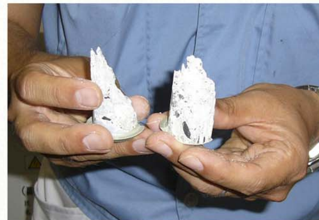
コアの破壊状況
