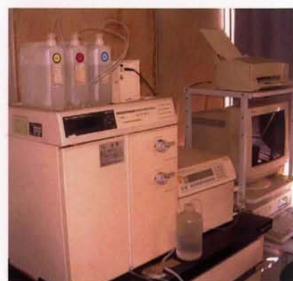
塩化物イオン量の測定状況
