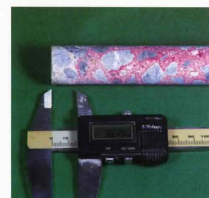
中性化深さの測定状況
