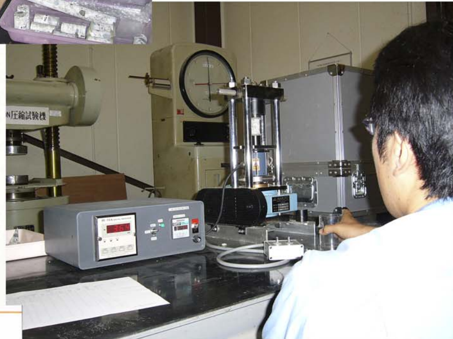
簡易な試験機(可搬式30kg)を用いて、現場でもリアルタイムに強度の推定が可能。
