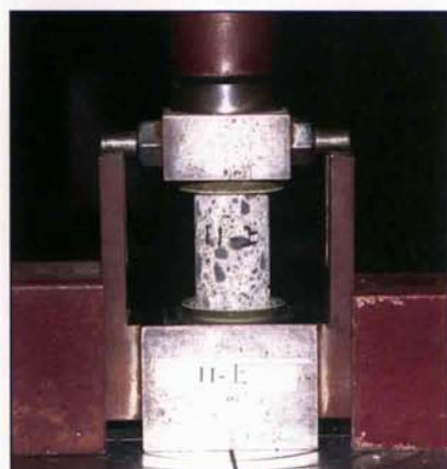
圧縮強度試験状況
