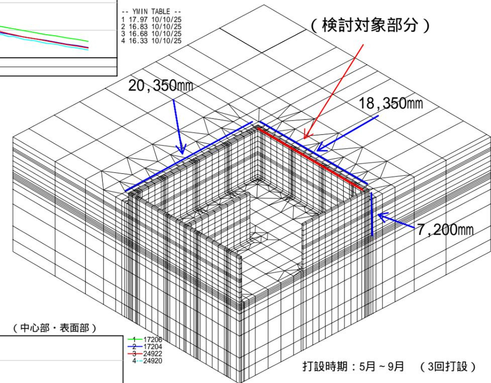
最小ひび割れ指数の分布と推移 (壁断面：モデル図赤ライン部分対象)
